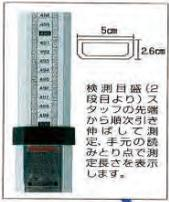
検測目盛(2段目より)スタッフの先端から取り引き伸ばして測定、手元の読み取りまで測定長さを表示します。
